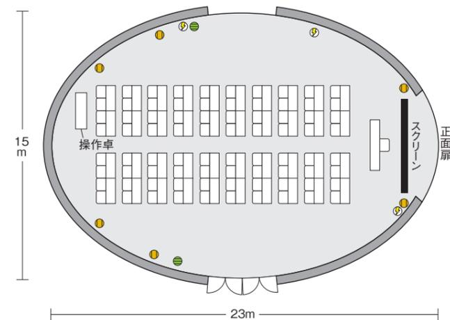
①光回線 ②コンセント(容量1.5kw×3) ③臨時電話回線/VDSL
